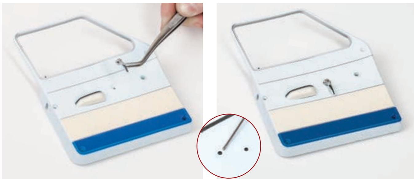
Установите внутреннюю ручку замка двери в средней части лицевой стороны обивки передней левой двери. Для совмещения центровочных элементов ручка должна быть направлена строго вниз. Зафиксируйте ручку с внутренней стороны обивки при помощи винта 1,7×3 (CP).
