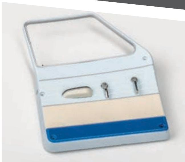
С лицевой стороны обивки установите ручку стеклоподъемника. На ось ручки с внутренней стороны обивки поместите шестерню ручки стеклоподъемника. Обратите внимание: на оси ручки и в отверстии шестерни имеются крепежные фаски, которые исключают проворачивание деталей относительно друг друга. Закрепите шестерню на оси при помощи винта 1,7×3 с пресс-шайбой (QP).
