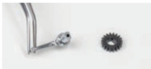
По окончании фиксации деталей проверьте подвижность шестерен на осях. Также убедитесь в работоспособности привода тяги стеклоподъемника от ручки. Установленные шестерни должны плотно входить в зацепление зубьями с соседними шестернями и исключать проскальзывание механизма привода. При необходимости подтяните или ослабьте крепежные винты шестерен.
