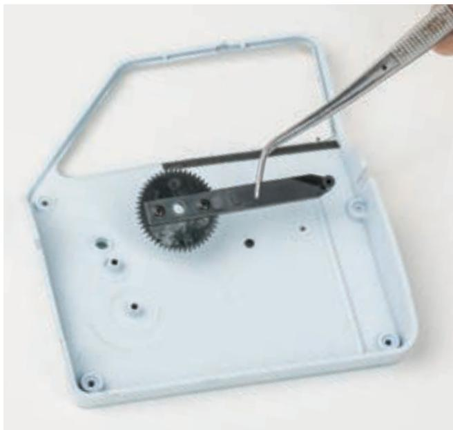
Установите собранную тягу стеклоподъемника на нижнюю ось с внутренней стороны обивки передней левой двери. Убедитесь в легкости вращения шестерни на оси обивки. При заедании деталей сточите пластик изнутри отверстия шестерни тяги стеклоподъемника. Зафиксируйте детали на обивке винтом 2,0×3 с пресс-шайбой (RP).
